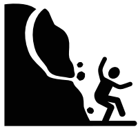
EFFONDREMENT DES PAROIS D'UN CREUSEMENT NON ÉTANÇONNÉ
